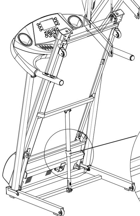
Слегка надавите на предохранительную трубку; продолжайте нажимать на трубку, опуская при этом беговую платформу в направлении, указанном стрелками. После этого тренажёр плавно опустится вниз.
