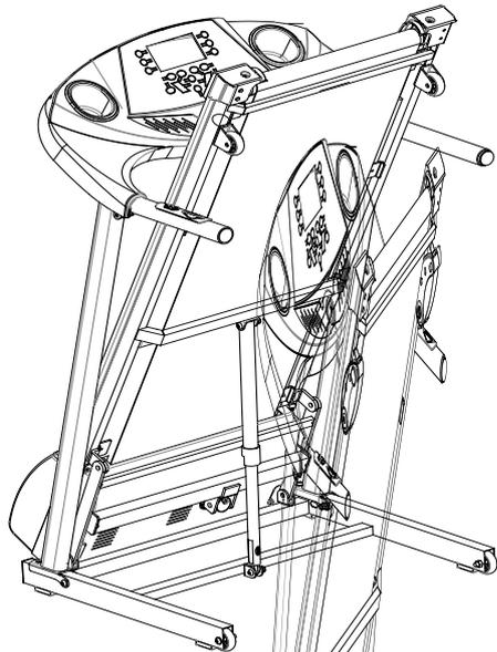
Поднимите беговую платформу к верхней части тренажёра и надавливайте на неё, прилагая усилия до тех пор, пока не услышите щелчок, который показывает, что предохранительный кожух защёлкнулся на пневматическом цилиндре.
